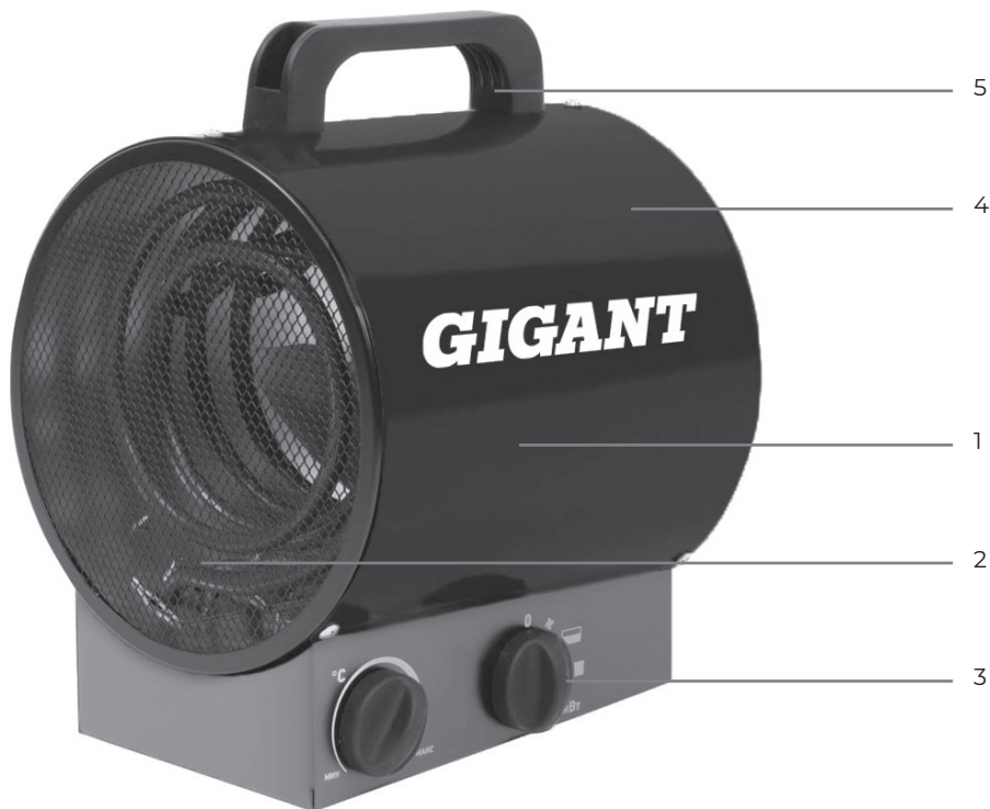
Рис. 1. Устройство прибора: 1) корпус, 2) воздуховыпускная решетка, 3) блок управления, 4) воздухозаборная решетка, 5) ручка
