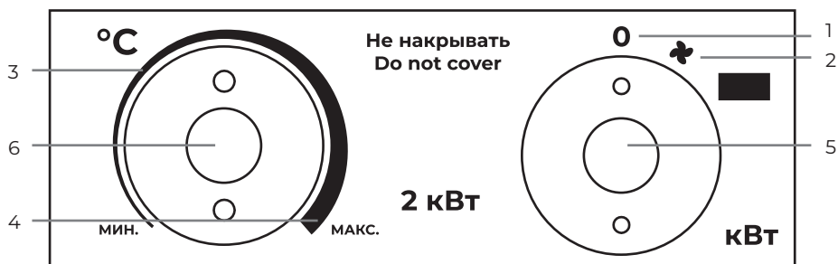
Рис. 2. Панель управления: 1) положение выключения прибора, 2) положение режима вентиляции без нагрева, 3) положение частичной мощности нагрева, 4) положение полной мощности нагрева, 5) ручка переключателя режимов, 6) ручка регулировки термостата
