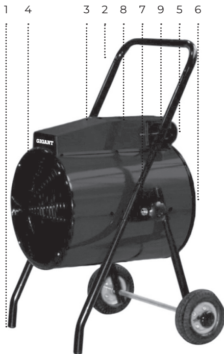
Рис. 1-2. Устройство прибора EHR-30: 1) колесная опора, 2) ручка, 3) поворотный корпус, 4) воздуховыпускная решетка, 5) блок управления, 6) воздухозаборная решетка, 7) барашковый винт, 8) кнопка сброса аварийного термостата, 9) трехфазная вилка
