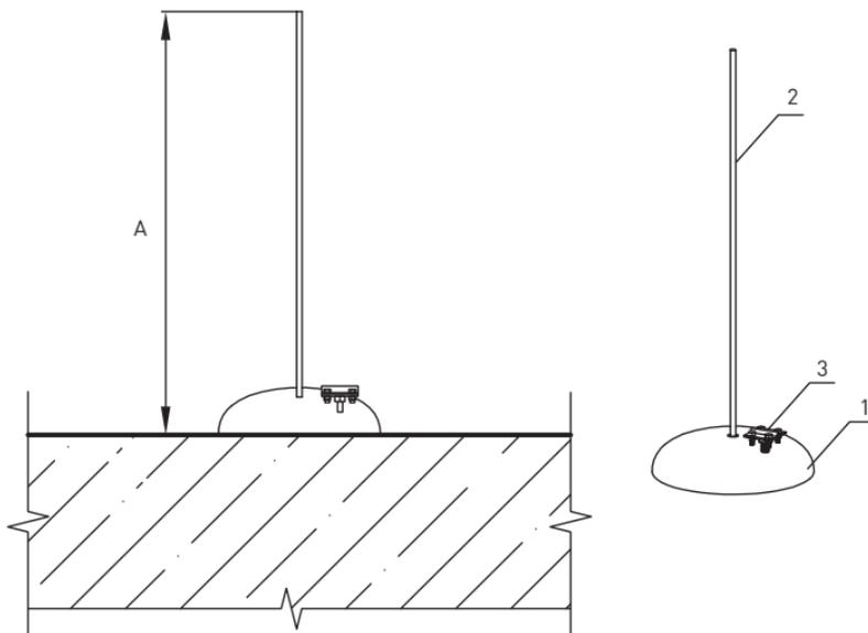
Рис. 5 – Крепление молниеприёмника к бетонному основанию
