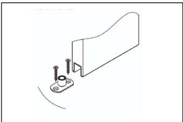
5. Закрепляем нижний направляющий ролик к полу с помощью саморезов.
