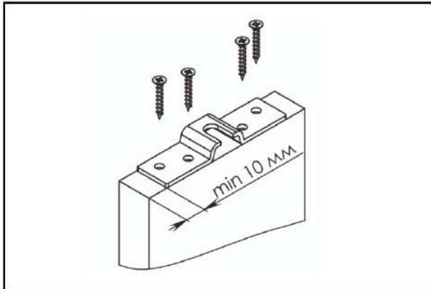
4. На верхнем торце двери с разных сторон закрепите монтажные пластины саморезами. Пазы должны быть направлены в одну сторону. Минимальное расстояние от края двери до начала монтажной пластины не менее 10мм.
