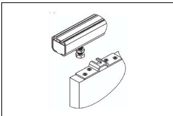
6. Навешиваем дверное полотно на регулировочные болты роликов и фиксируем их зажимной гайкой.
