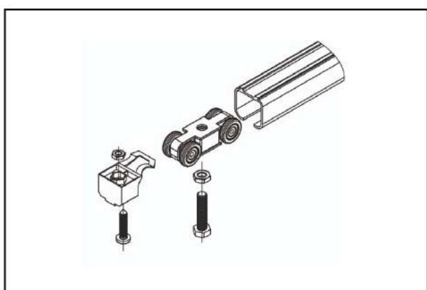
1. В верхнюю направляющую устанавливаем ролики, предварительно наживив регулировочные болты с гайками, а также стопоры с гайками и винтами.
