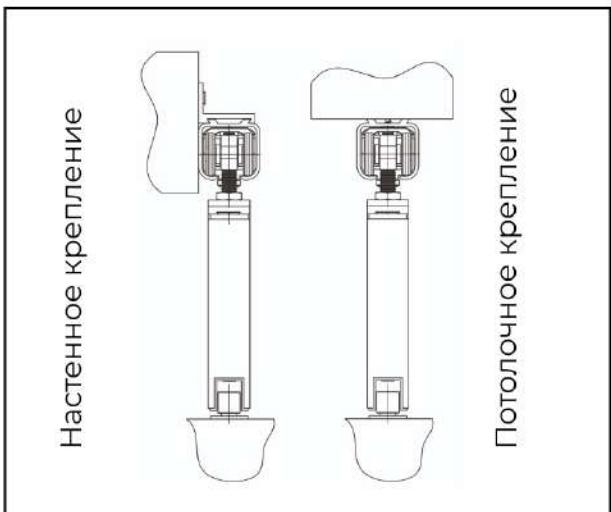
7. Выбираем необходимое положение стопора ролика и фиксируем их винтом.
