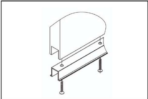
3. Устанавливаем нижнюю направляющую в дверное полотно, в заранее отфрезированный паз, и фиксируем ее саморезами.
