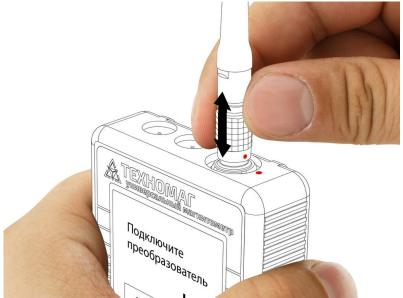
**Внимание!** В приборе используется разъем с механической фиксацией вилки и розетки типа Push-Pull.
