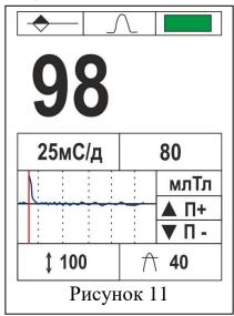
Примечание - В качестве примера на рисунке 11 представлен результат измерения прибором магнитного импульса, создаваемого импульсом тока, протекающим по медному стержню намагничивающей установки УНИР-2014МЦ
