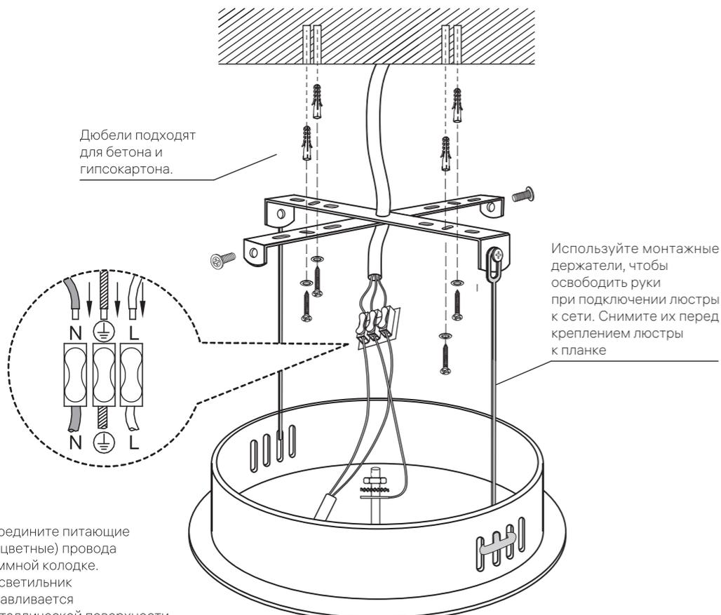
Подсоедините питающие (одноцветные) провода к клеммной колодке. Если светильник устанавливается на металлической поверхности, поверхность должна быть заземлена.
