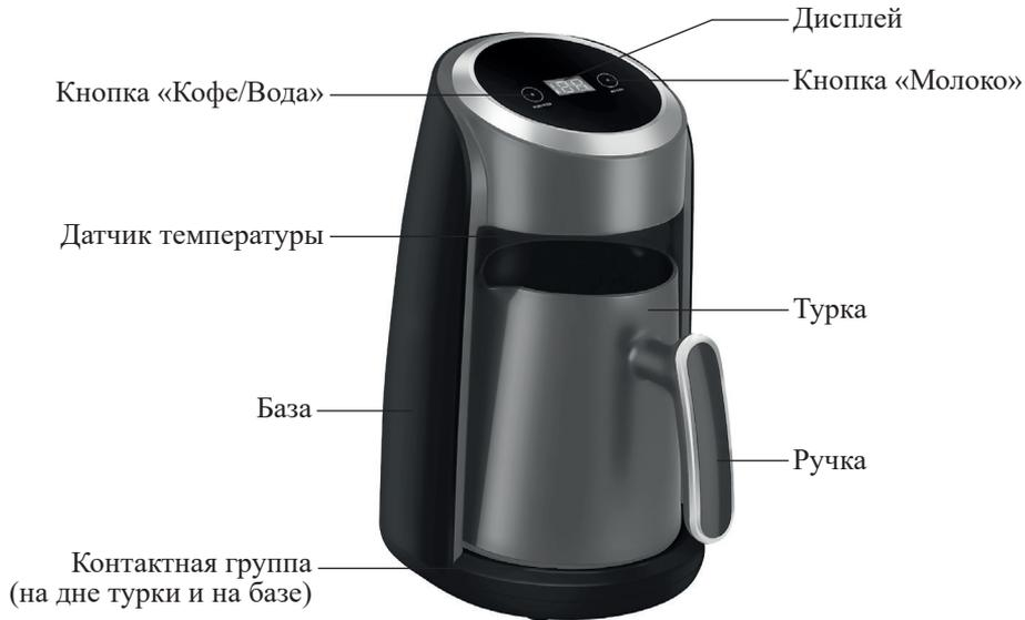
Электрическая турка состоит из базы и турки. На верхней части базы находятся дисплей и панель управления. На нижней части базы и на дне турки находятся электрические контакты. Турка устанавливается на базу наподобие электрического чайника. По достижении определенной температуры (100 °С для кофе или воды, 60 °С для молока) турка автоматически отключается.
