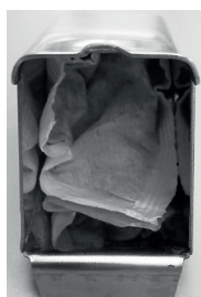
Пакетик с активированным углем, вложенный в носик
