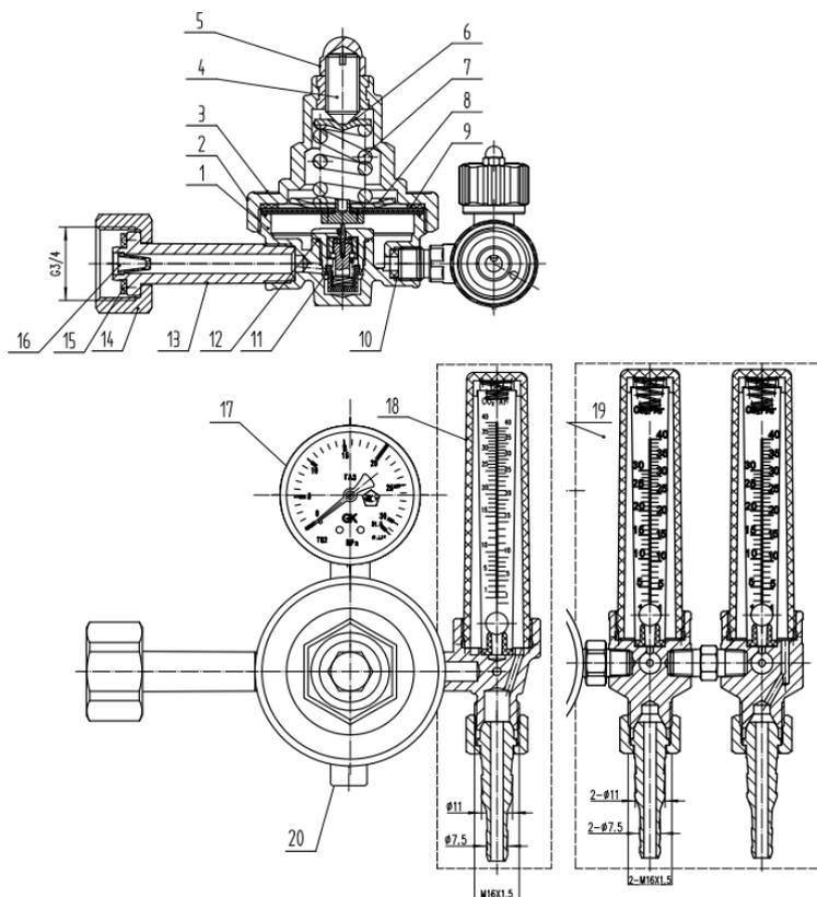
Рис. 2. Регулятор расхода газа баллонный одноступенчатый с ротаметром Base Control SE FLOW:
