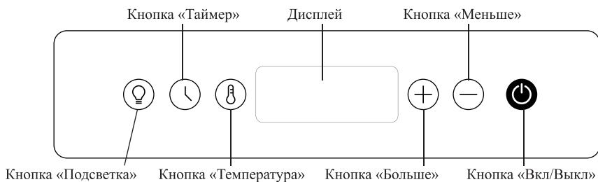
**Кнопка «Вкл/Выкл»** включает и отключает устройство.
