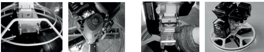
4. Закрепите рукоятку управления на редукционном блоке
