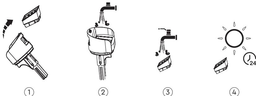
1. Достаньте фильтр из крышки резервуара для грязной воды и мусора.
