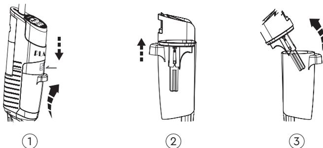
1. Нажмите на красную кнопку над резервуаром, отсоедините резервуар от основного корпуса, потянув резервуар на себя.
