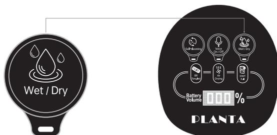
Нажатием на кнопку «Wet/Dry» на цифровом дисплее включается режим влажной уборки, звучит звуковое уведомление: «Wet stencil», – индикатор «Wet/Dry» на дисплее непрерывно горит.
