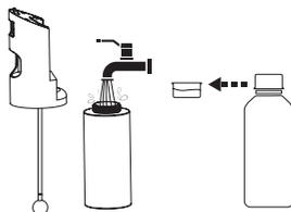
Откройте крышку резервуара для воды и наполните его чистой теплой водой 60°C.
