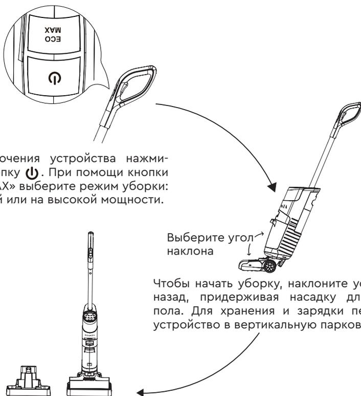
Для включения устройства нажмите на кнопку
