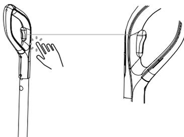
Регулировка уровня подачи воды для влажной уборки регулируется при помощи кнопки на ручке пылесоса.
