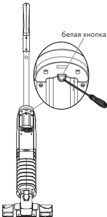
Вставьте алюминиевую ручку в основной корпус прибора, Вы услышите характерный звук – щелчок.
