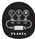
На дисплее проверьте уровень заряда прибора. Желательно перед началом уборки заряжать прибор на 100%.
