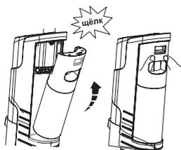
Совместите дно резервуара для чистой воды с пазами на основном корпусе устройства и прижмите резервуар к корпусу до тех пор, пока не услышите щелчок.
