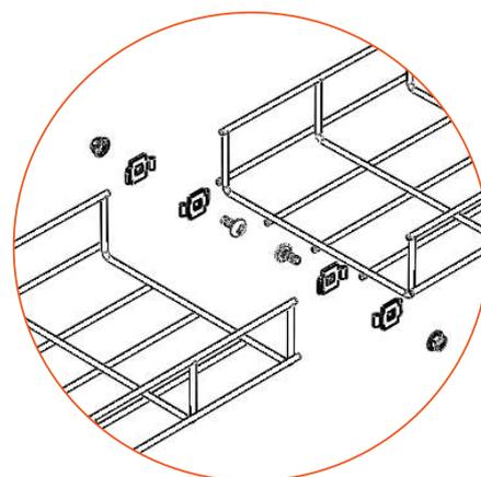
**Соединитель проволочного лотка безвинтовой СПБ**
