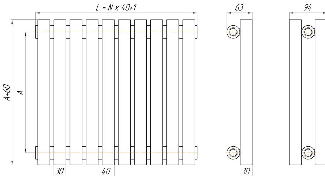
Рис 1 А – межцентровый монтажный размер, N – количество секций.
