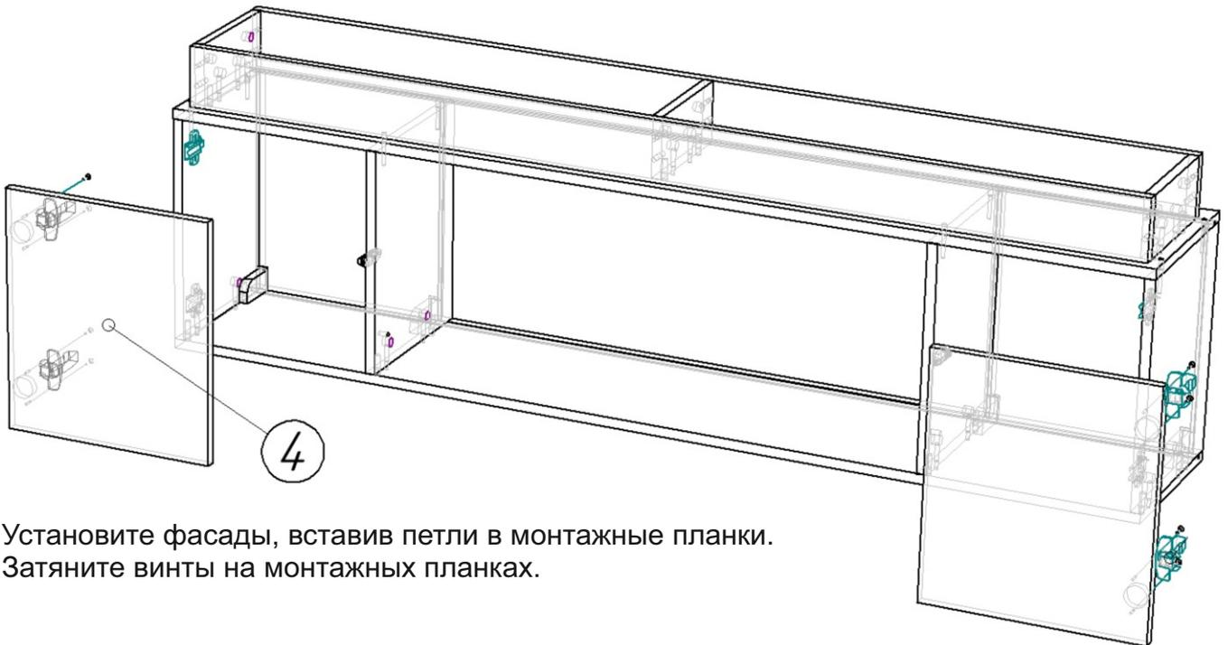
Установите фасады, вставив петли в монтажные планки. Затяните винты на монтажных планках.
