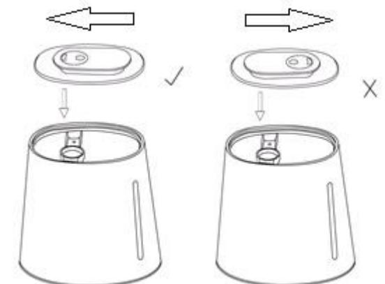
В донной части корпуса прибора расположен отсек с губкой для ароматических масел. Для достижения желаемого эффекта достаточно открыть отсек, и нанести на губку 2-3 капли арома-масла. Затем установить крышку отсека на место. В ходе работы прибор будет распылять частицы арома-масла вместе с мельчайшими водяными каплями. После каждого использования губку рекомендуется мыть мыльным раствором. Перед повторным использованием полностью высушить.
