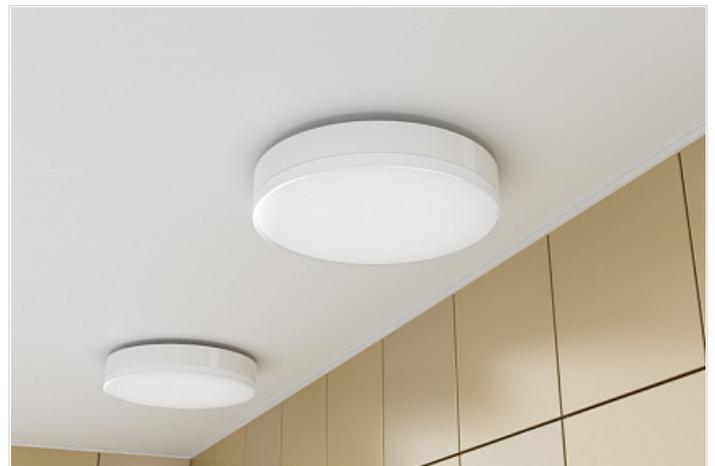
Общая информация Светильники серии ТАБ I применяются для накладного монтажа. Светильники выполнены в пластиковых корпусах с повышенной защитой от воздействия окружающей среды – IP54. Рассеиватель выполнен из прочного опалового светостабилизированного поликарбоната. Светильники могут устанавливаться на улице под навесом, вне зоны прямого попадания воды. Светильники устойчивы к перепадам рабочего напряжения и частым включениям. Стандартная комплектация: опаловый рассеиватель.
