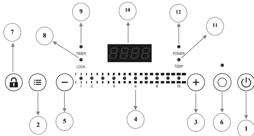
Подключите прибор к сети питания. После звукового сигнала на дисплее загорится OFF, включится вентилятор охлаждения.
