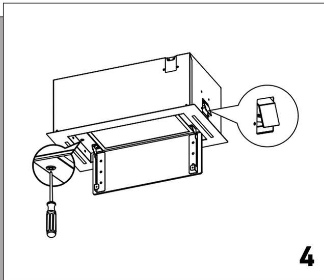
Перед установкой откройте панель и отверткой поверните болт по часовой стрелке, чтобы ослабить его для облегчения установки. Ослабьте крепежную конструкцию, плотно прилегающую к корпусу, с помощью отвертки, чтобы облегчить установку вытяжки.
