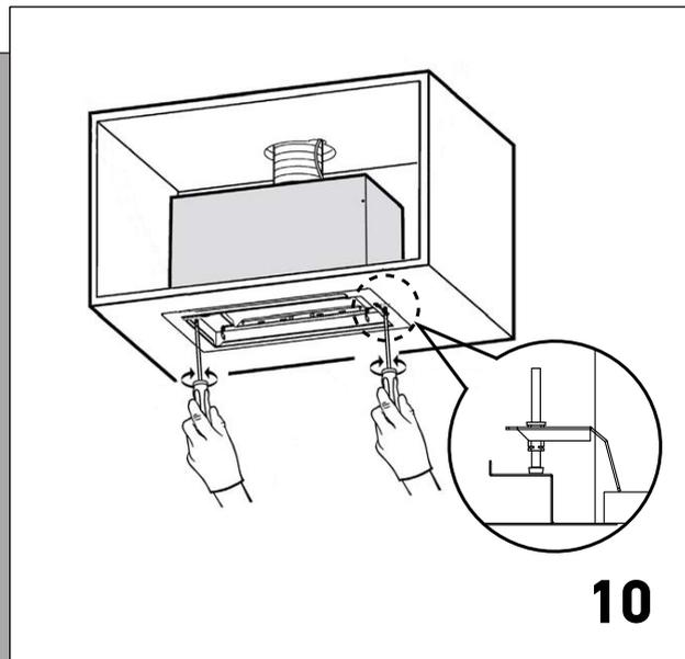
Откройте панель и отверткой открутите два крепежных винта. Поднимите вытяжку, пока она не будет полностью установлена в нижней части шкафа. Затяните винты, крепящие вытяжку.
