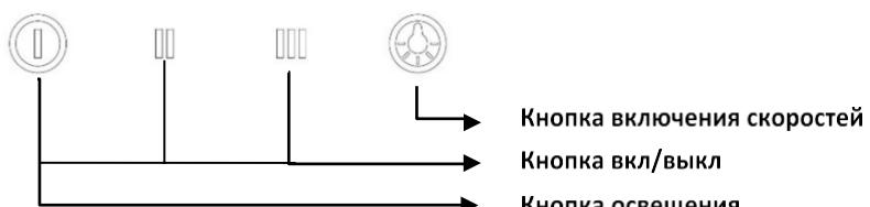
**Кнопка Вкл/Выкл:** Прикосновение к этой области начнет работать на 1-м уровне скорости при включении продукта. Нажмите на это поле, чтобы выключить продукт во время его работы.
