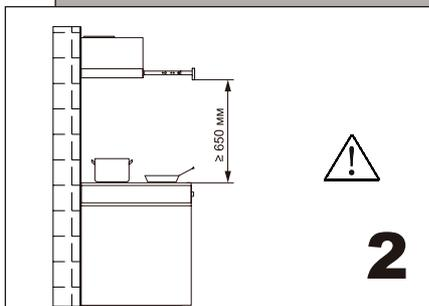
Рекомендуемое расстояние между нижней частью вытяжки и ближайшим нагревающим элементом плиты должно быть не меньше 650 мм и не больше 750 мм.
