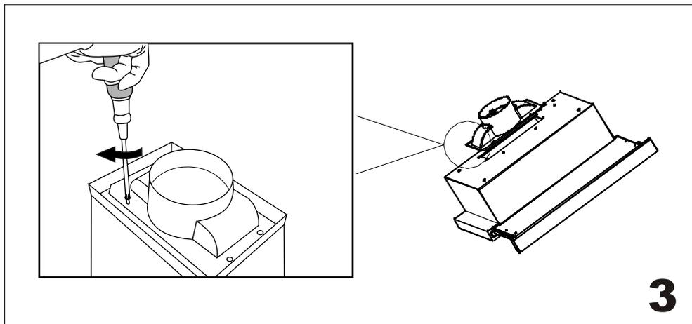
Перед установкой вытяжки сначала установите обратный клапан.
