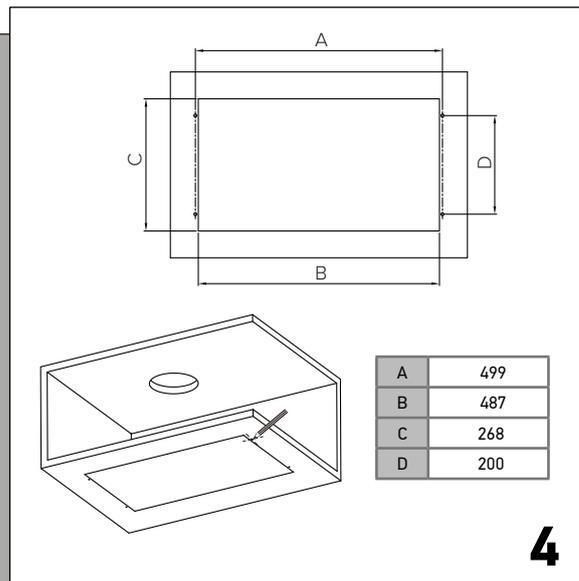
Подготовьте разметку в месте крепления вытяжки в шкаф, опираясь на ее внешние размеры.
