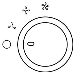
Нажмите на блок управления перед тем, как включить вытяжку, чтобы ручка выскочила. Поверните ручку по часовой стрелке, чтобы указать оптимальную скорость вентилятора.
