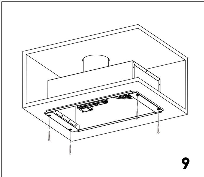
Установите вытяжку в кухонный шкаф, используя имеющийся крепеж. Надежно закрутите саморезы.
