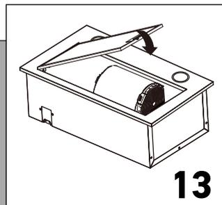
В режиме рециркуляции воздух выводится обратно на кухню через выходное отверстие в вытяжке. Этот метод рекомендуется, если вы не используете варочную панель интенсивно. Режим рециркуляции воздуха требует использования угольных фильтров для удаления неприятных запахов.
