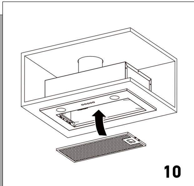
Смонтируйте нижнюю панель вытяжки, используя ранее выкрученные 4 винта.
