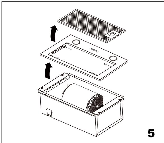
Демонтируйте жировой фильтр, выверните 4 винта на нижней панели вытяжки, демонтируйте панель.
