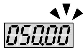
При остановленном двигателе на дисплее индицируется заданная частота, значащие разряды дисплея мигают. Нажатие в этот момент кнопок **ВВЕРХ** или **ВНИЗ** позволяет изменять значение заданной частоты. При этом мигает разряд индикатора, доступный для корректировки кнопками **ВВЕРХ** и **ВНИЗ**. Перемещение между разрядами обеспечивается кнопкой **ВВОД/ВЛЕВО**. Каждое нажатие этой кнопки приводит к перемещению мигающей цифры на один разряд влево.
