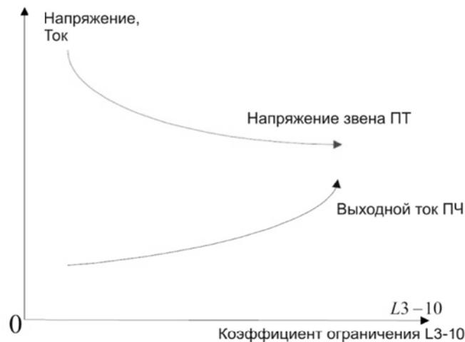
Коэффициент L3-10 – это параметр, который позволяет снизить напряжение звена ПТ преобразователя частоты (параметр монитора U1-07) при торможении инерционной нагрузки, но при этом повышается выходной ток.
