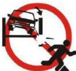
Покиньте рабочую зону подъемника, если есть риск падения автомобиля.
