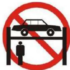
Освободите рабочую зону под подъемником во время спуска автомобиля.
