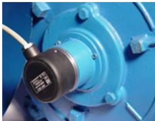
Рис. 3.1. Энкодер на валу двигателя
