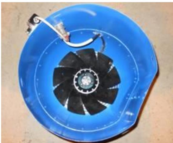
Рис. 2.2. Узел независимой вентиляции
