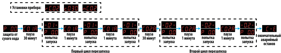
Графическое представление работы режима перезапуска “rC.02”
