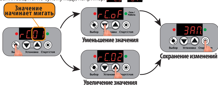
Графическое представление работы режима перезапуска “rC.02”
