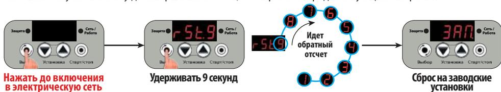
Включить в электрическую сеть с нажатой кнопкой “Выбор”
