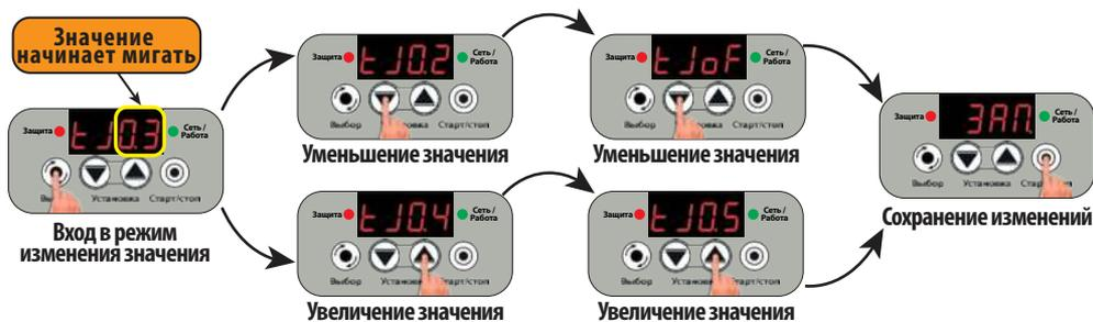
29.5 “JXX.X” – мощность в конце фазы интенсивного разгона в процентах от полной мощности насоса. Параметр “JXX.X” задается автоматически при переводе параметра “tJX.X” из “tJoF” в ненулевое значение. При этом, при сохранении значения параметра “tJX.X” (п. 29.4) на дисплее появится параметр “JXX.X”.
