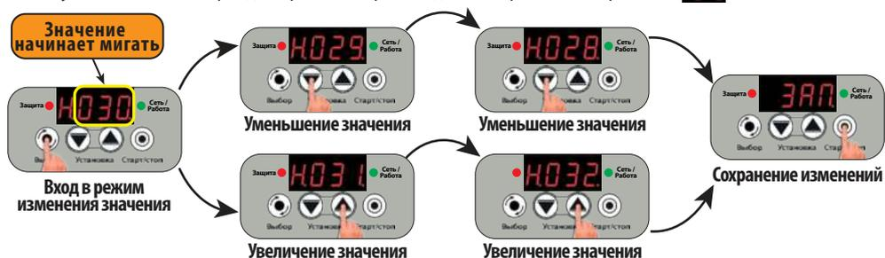
27.5 “nH.XX” – количество последовательных отключений насоса по функции “недобор давления”, при давлении в системе выше уровня “РНХ.X” (п. 26.1, стр. 22) до перехода ЭБУН в режим аварии “H-E”. Последовательными считаются отключения, если между ними насос не выключался по уровню “РвХ.X” или по какому-либо аварийному режиму, а также работа ЭБУН не была прервана нажатием кнопки “Старт/стоп” или “Выбор”.
