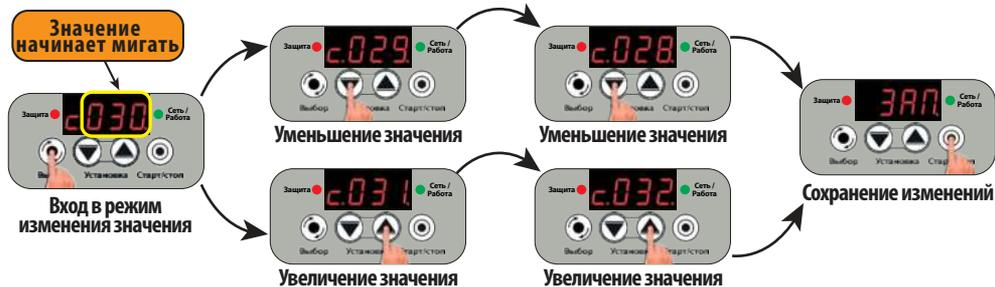
28.3 “nC.XX” – количество циклов автоматического перезапуска насоса после срабатывания защиты по сухому ходу для режима “rC.02” (п. 28.1, стр. 30). Насос перезапустится “XX” раз для проверки появления воды в источнике до достижения давления в системе уровня “PCX.X”.
