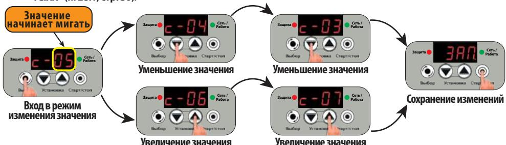
27.3 "Р.ХХХ" – задержка срабатывания защиты от "разрыва" в секундах. Если при работающем насосе давление в системе водоснабжения не может подняться до уровня "РХХ.Х" в течение времени "Р.ХХХ", то ЭБУН отключит насос для предотвращения большого расхода воды, затопления помещений или безостановочной работы насоса при возможном "разрыве" трубопроводов. На дисплее при этом отображается **Р-Е**.
