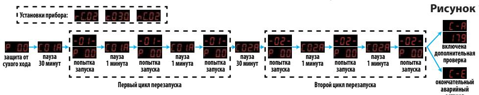
28.2 "с.XXX." – пауза в минутах до следующего включения насоса для проверки появления воды в источнике в режиме автоматического перезапуска после срабатывания защиты по сухому ходу для режима "гC.02" (п. 28.1, стр. 30).
