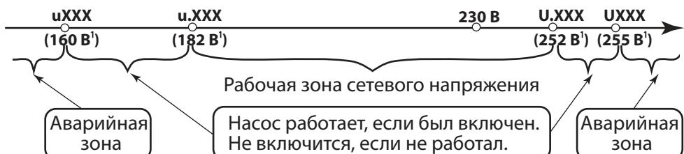
1 Значение напряжения в соответствии с заводскими настройками, точность измерения напряжения  $\pm 2\%$
