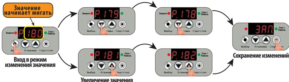
27.4 "H.XXX." – задержка срабатывания защиты от "недобора давления" в минутах. Если после включения насоса давление в системе водоснабжения не может подняться до уровня "PHX.X" в течение времени "H.XXX.", то ЭБУН отключит насос с целью защиты системы от больших утечек, работы насоса без воды, а также в случае ухудшения параметров его производительности и предупреждения о засорении входных фильтров.
