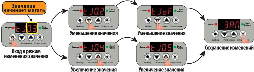
29.5 "JXX.X" – мощность в конце фазы **интенсивного разгона** в процентах от полной мощности насоса.
