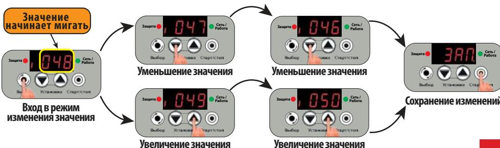
30.10 “С.ХХХ” – время всасывания для защиты от сухого хода по электрическим параметрам. Если в течение времени “С.ХХХ” насос не начнет перекачивать воду, то ЭБУН его выключит, а на дисплее будет отображаться информация в соответствии с настройками параметра “гС.ХХ” (п. 28.1, стр. 30).
