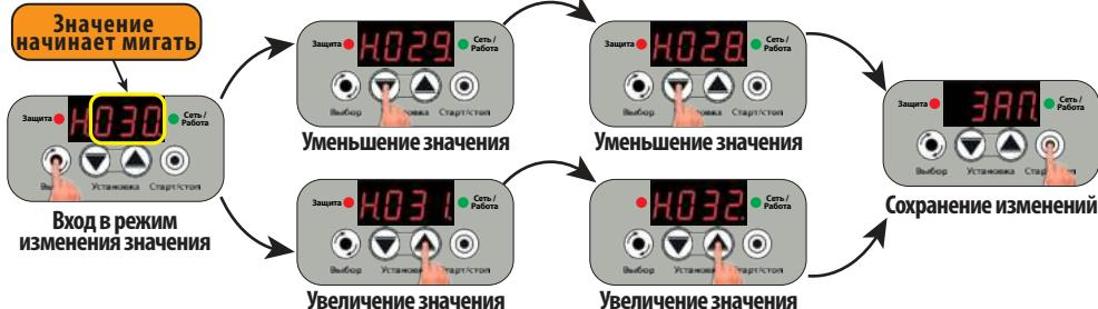
27.5 "пН.XX" – количество последовательных отключений насоса по функции "недобор давления", при давлении в системе выше уровня "РХХ.Х" (п. 26.1, стр. 22) до перехода ЭБУН в режим аварии **H-E**. Последовательными считаются отключения, если между ними насос не выключался по уровню "РХХ.Х" или по какому-либо аварийному режиму, а также **работа ЭБУН не была прервана** нажатием кнопок "Старт/стоп" или "Выбор".
