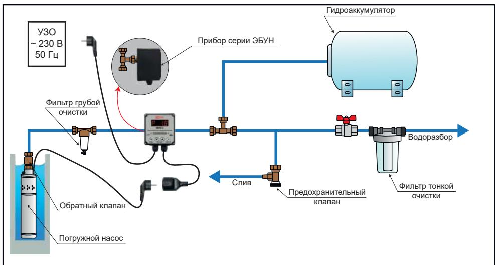
**Пример 3. Подключение ЭБУН-Ст к поверхностному насосу или насосной станции.**
