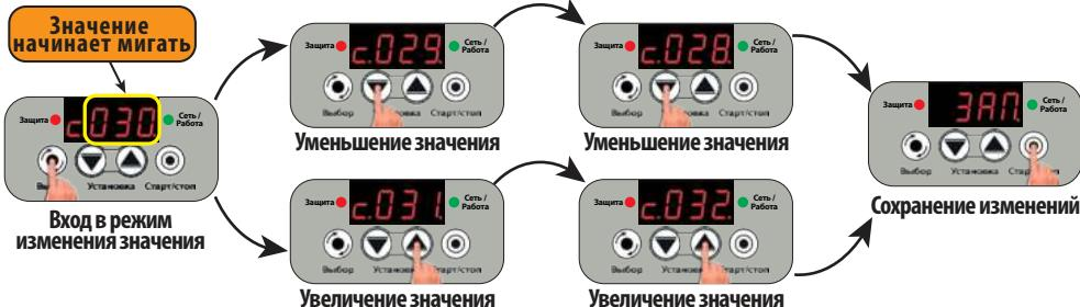
28.3 "nC.XX" – количество циклов автоматического перезапуска насоса после срабатывания защиты по сухому ходу для режима "гC.02" (п. 28.1, стр. 30). Насос перезапустится "XX" раз для проверки появления воды в источнике до достижения давления в системе уровня "PCX.X".
