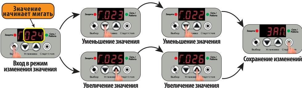
27.8 "td.XX" – интервал неизменности давления в секундах (функция "дельта"). Если при работающем насосе, давление в системе не меняется более чем на 0.3 бар в течение "td.XX", то насос будет отключен, а на дисплее выводится "dXX.A" ↔ Р.XX", где "XX" – номер остановки, а "X.X" – давление в системе, например: **d0.18 ↔ Р.25**.
