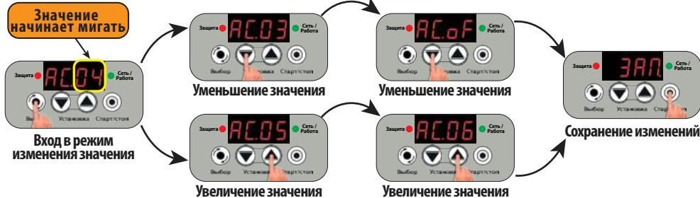
28.6 "t.XXX." / "t.oFF" – максимальное время непрерывной работы насоса после включения в минутах. Если после включения насоса в течение "XXX" минут давление в системе не сможет достичь уровня "РвХ.", то он будет выключен принудительно, а ЭБУН перейдет в режим паузы на время, установленное в п. 28.7, стр. 33, а на дисплее будет отображаться "t.ПАУ↔XXX." или "t.ПАУ↔XX.XX", например:
