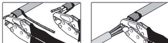
7. Надвинуть kleевую термоусадочную трубку d=19.1 мм, длиной 100 мм и термоусадить ее с помощью промышленного фена. Нагревать трубку необходимо с середины к краям, чтобы не образовался пузырь воздуха.
