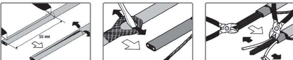
3. Концы внутренних жил саморегулирующегося кабеля подровнять следующим образом: токоведущие жилы =14 мм/жгут из экранирующей оплетки (при наличии) =22 мм.
