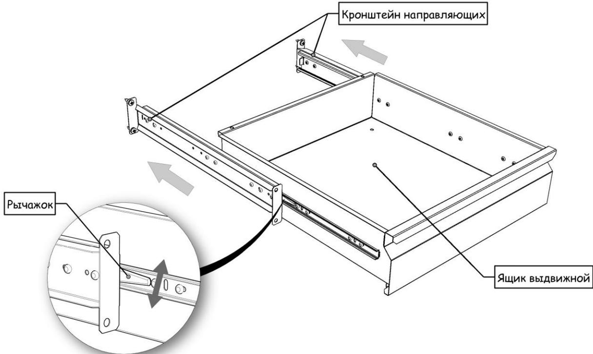
Определите, в каком месте будет установлен ящик (ящики). Разместите кронштейны внутри корпуса между профильными частями боковых стенок (перегородки). Закрепите через отверстия кронштейны к корпусу при помощи 8-и самонарезающих винтов 6,3x19мм., как показано на рисунке. Винты идут в комплекте с ящиком выдвижным.
