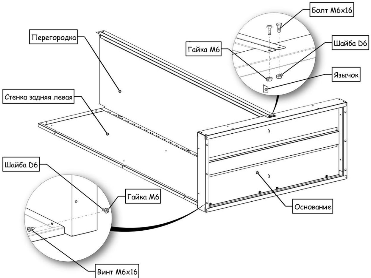
Установите панель верхнюю как указывают линии на рисунке, соедините перегородку и лицевую часть панели через совпадающие отверстия (обозначены пунктиром) при помощи 2-х болтов М6х16мм. шайб и гаек М6, далее соедините торцевую часть перегородки и стенки задние с панелью при помощи 6-и винтов М6х16мм. шайб и гаек М6, также не затягивая.
