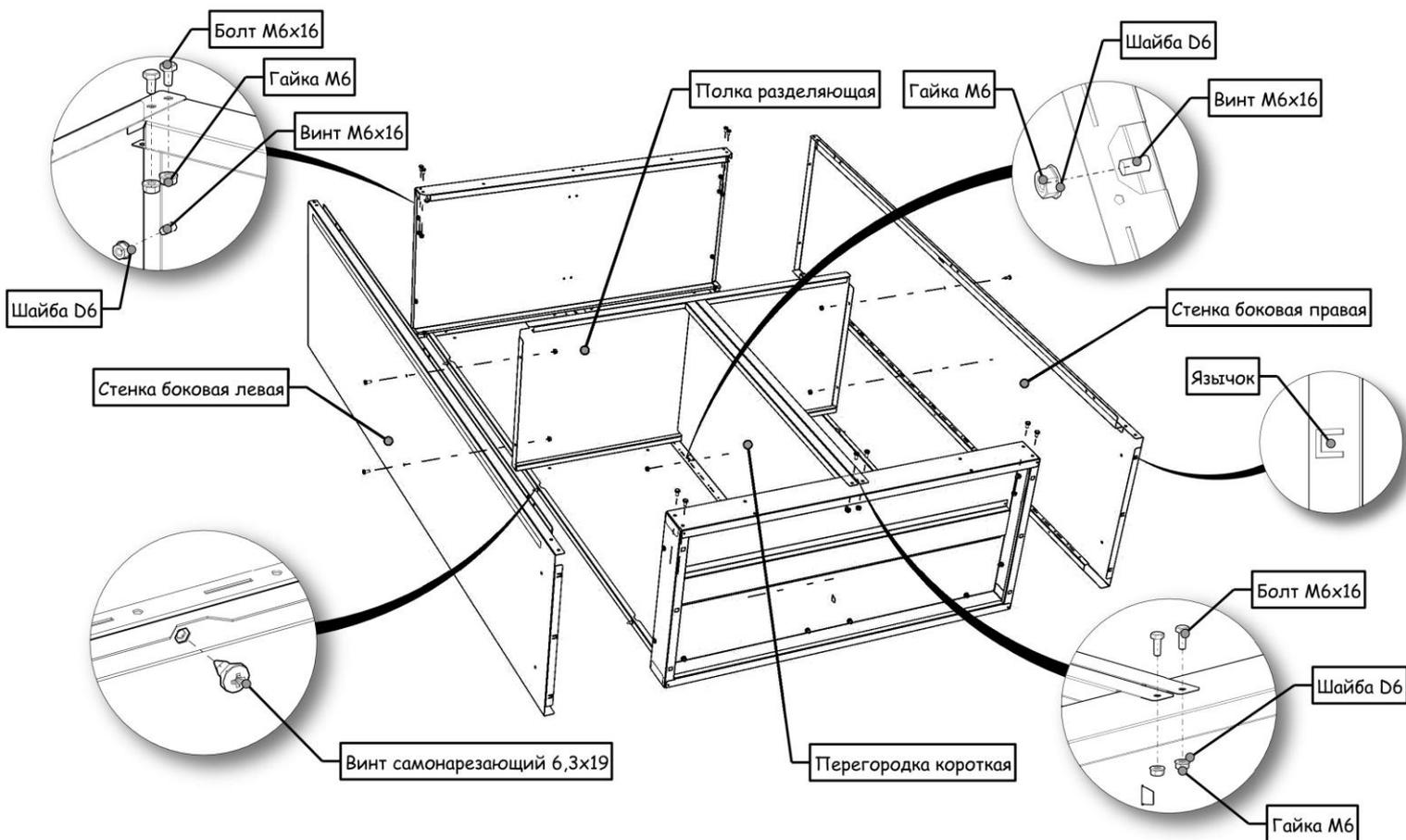
Установите панель лицевую верхнюю как указывают линии на рисунке, совместив резьбовые втулки, установленные на внутренней части панели лицевой, с отверстиями на передней части панели верхней,
