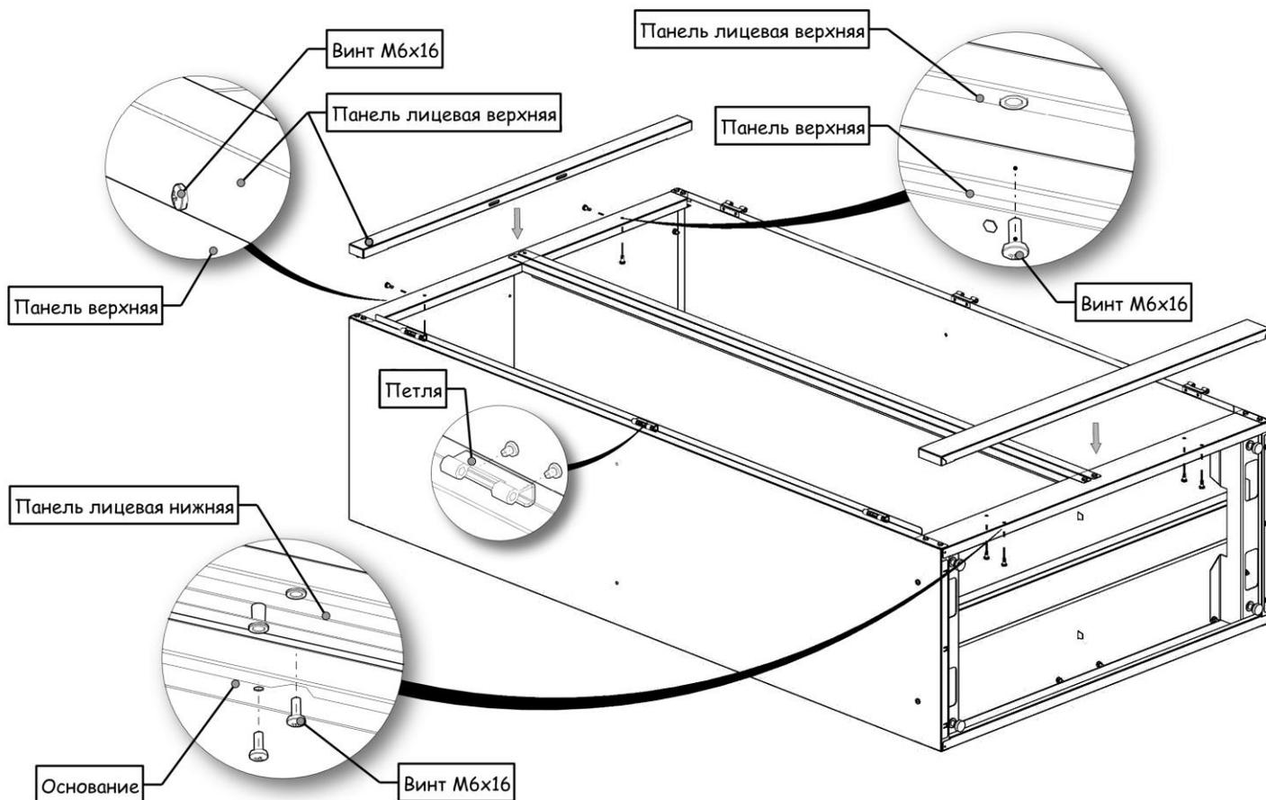
Установите корпус в вертикальное положение. Разместите внутри шкафа или антресоли, сверху на задних стенках, панели задние перфорированные. Совпадая отверстия на элементах закрепите панели при помощи 8-и винтов М6х16мм. шайб и гаек М6.
