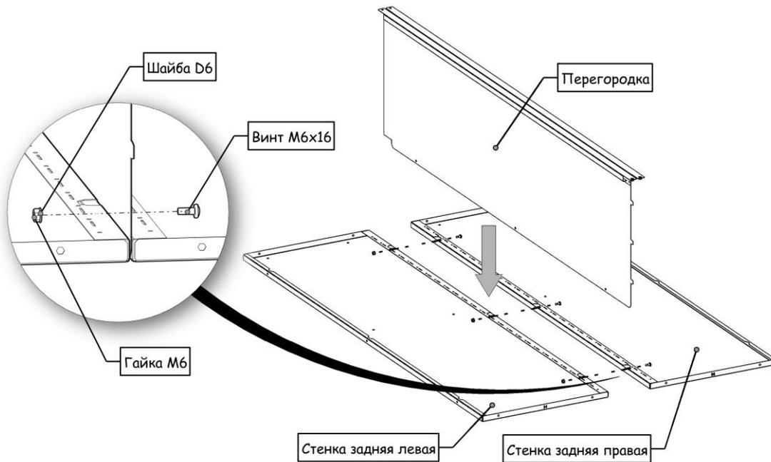
Установите основание в нижней части стенок и перегородки как показано на рисунке, язычки расположенные на перегородке должны попадать в пазы на основании, соедините перегородку и основание через совпадающие отверстия (обозначены пунктиром) при помощи 2-х болтов М6х16мм. шайб и гаек М6, затем соедините задние стенки и основание в середине при помощи 2-х винтов М6х16мм. шайб и гаек М6, не затягивая. Крайние отверстия оставьте без крепежа.
