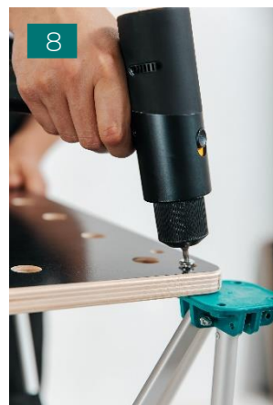
8. С помощью ключа (идет в комплекте) или шуруповерта прикрутить столешницу к подстолью.
