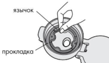
Чтобы снять прокладку с нижней части крышки-пробки, достаточно потянуть её за язычок.
