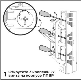
**1** Открутите 3 крепежных винта на корпусе ППВР
