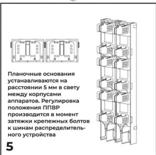
Планочные основания устанавливаются на расстоянии 5 мм в свету между корпусами аппаратов. Регулировка положения ППВР производится в момент затяжки крепежных болтов к шинам распределительного устройства
