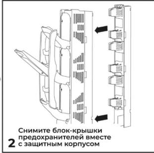
**2** Снимите блок-крышки предохранителей вместе с защитным корпусом
