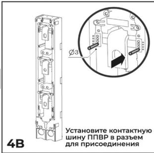
**4B** Установите контактную шину ППВР в разъем для присоединения
