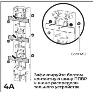
**4A** Зафиксируйте болтом контактную шину ППВР к шине распределительного устройства
