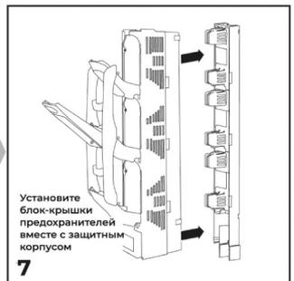
Установите блок-крышки предохранителей вместе с защитным корпусом
