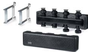
1029 Коллектор компактный с изоляцией и настенным креплением. Расход до 3,5 м³/h 70 Kw с Δt 20 K.
