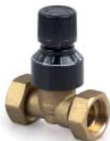
1024 Дифференциальный перепускной клапан с вращающимися гайками, калибровка: от 0,2 до 2,5 бар.
