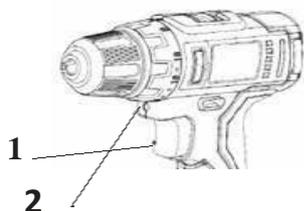
1 - Клавиша пускового выключателя;
