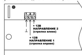
\*Примечание: при одновременной подаче потенциала +12В на клеммы 2 и 3 стрелка включается в оба направления.
