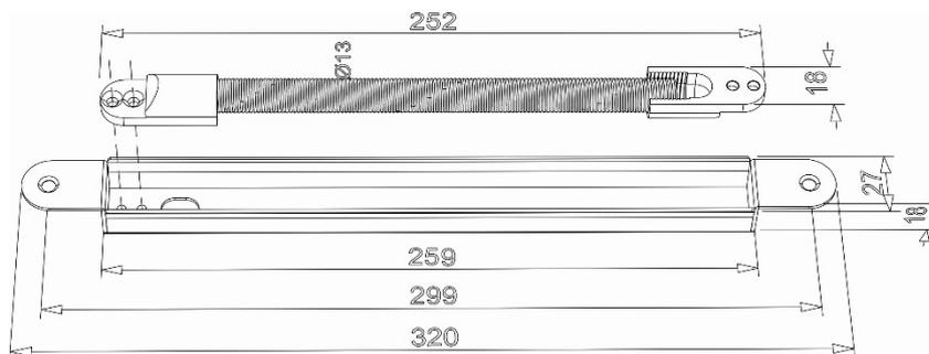
Гибкий кабелепереход ST-DL440 предназначен для защиты кабеля, идущего от рамы к дверному полотну. Врезная конструкция обеспечивает скрытый подвод кабеля к замку двери.
