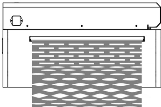
Вставьте картон в слот для подачи. Максимальная толщина картона составляет 10 мм - не загружайте картон с усилием в перфоратор. Картон любой ширины можно подавать в аппарат, так как он срежет лишнюю ширину.
