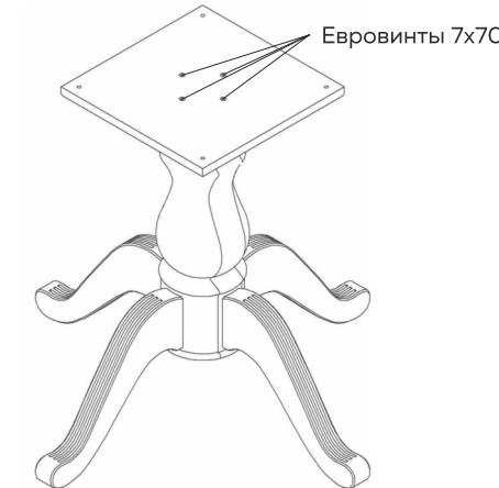
**5** Собранную колонну присоединить к крышке с помощью ранее открученных винтов M6x30 и шайб, как показано на рисунке.
