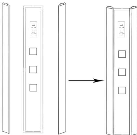
**6, Установить задние стенки и центральную панель. Используйте саморез М4Х10 (А3). Затем установите горизонтальный профиль к задней стенке.**
