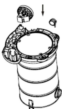
1. Установите роликовые колеса в отверстие на основании.
