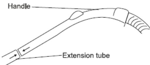
Вставьте ручку в трубку с усилием скручивания.
