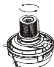
Поверните фиксирующую ручку с усилием против часовой стрелки, снимите фильтры
