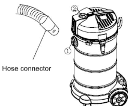
Вставьте соединитель шланга в положение (1), функция всасывания доступна
