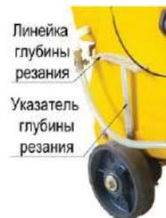
Рис. 3. Указатель глубины реза
