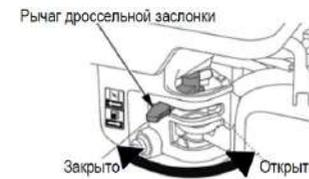
Рис. 10. Рычаг дроссельной заслонки
