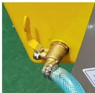
Рис. 13. Кран системы подачи воды
