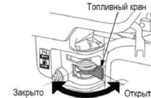
Рис. 8. Топливный кран
