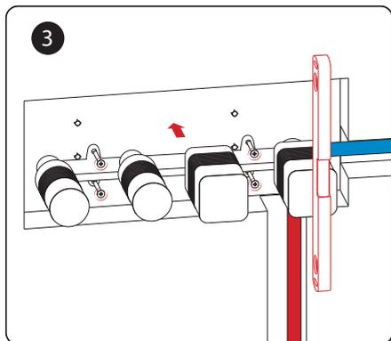
Используя уровень, установите блок на стену и отметьте положение крепежных выступов (x4), просверлите отверстия и прикрепите встроенный блок к стене с помощью винтов и анкеров.
