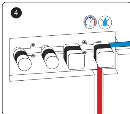
Проверьте все соединения на герметичность.
