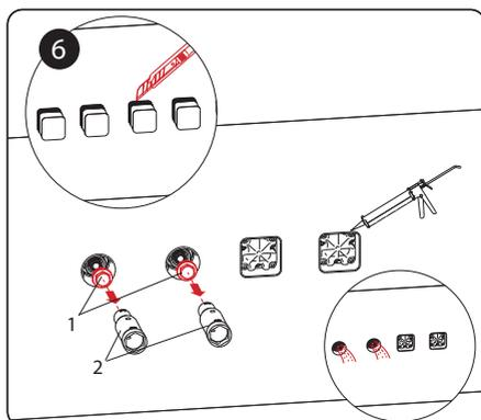
Следя линии разреза на коробке, отрежьте выступающую часть коробки. После укладки облицовки нанесите водостойкий герметик на край плитки. Извлеките пробки (1) с помощью сервисного ключа (2). Прикрутите соединительные трубки в резьбовые отверстия. Накрутите гайку на соединительную трубку для установки излива и зафиксируйте ее с помощью сервисного ключа.
