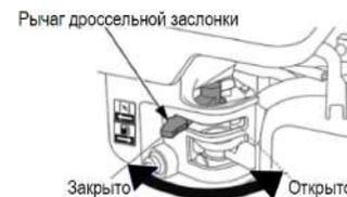
Рис. 10. Рычаг дроссельной заслонки
