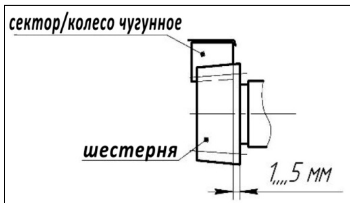
Рис. 6. Допустимый зазор
