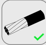
После снятия изоляции, токопроводящая жила не должна иметь поврежденной поверхности витков, смещение или перекручивание жил, срез изоляции должен быть ровным, без трещин и деформаций
