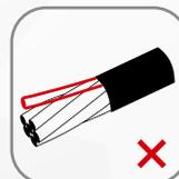
Расщепление витков проволоки может привести к снижению пропускной способности провода, ввиду вероятного обламывания жил.
