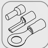
Перед снятием изоляции, необходимо определить вид и размер наконечника, клеммы, разъема с целью выявления длины очистки провода/кабеля от изоляции
