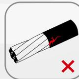
Обращайте внимание на срез изоляции! Не допускайте образования трещин и чрезмерного уменьшения толщины оболочки, во избежание последующего отслаивания изоляции от провода
