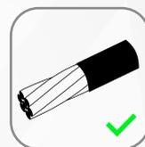
После снятия изоляции, токопроводящая жила не должна иметь повреждений поверхности витков, смещение или перекручивание жил, срез изоляции должен быть ровным, без трещин и деформаций
