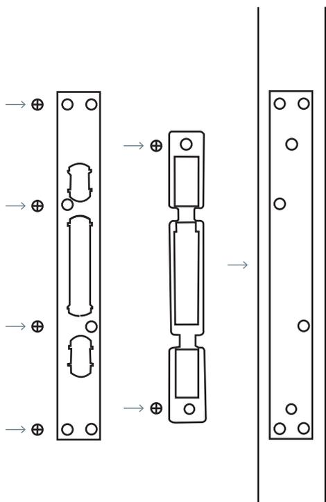
Для того, чтобы замок запирался, в дверной коробке напротив врезного механизма требуется выполнить отверстия для защелки и ригелей.
