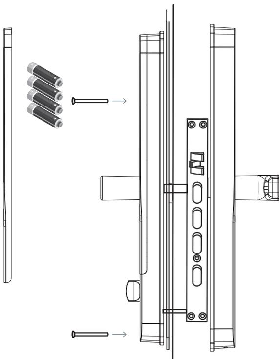
Соедините внешнюю и внутренние панели между собой при помощи винтов (7) и (8). Убедитесь, что панели надежно закреплены между собой, но при этом винты не перетянуты и панели не деформированы. В противном случае механизм замка будет работать некорректно.
