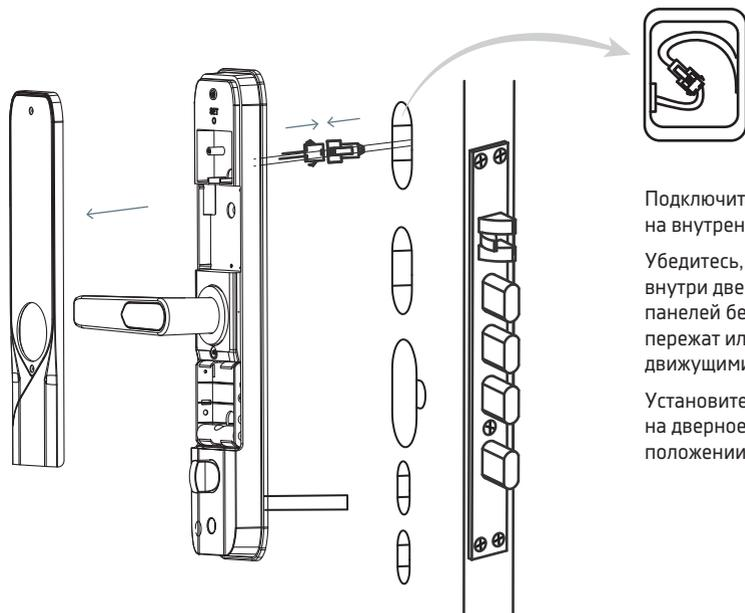
Подключите разъем кабеля к разъему на внутренней панели замка.
